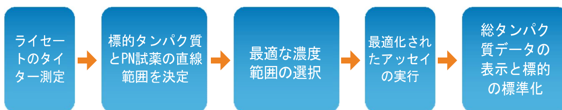
図 7. 総タンパク質アッセイと標的タンパク質の標準化のためにSimple Western assayを開発および最適化するためのワークフロー。
