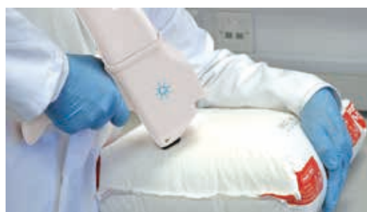
図 2. 不透明プラスチック製袋越しの同定試験
